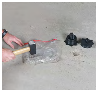
Fase 2: sminuzzamento del materiale campione in modo tale che l'intero materiale sottoposto a prova non presenti una granulazione maggiore di 8 mm.
