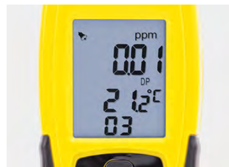
Il display LCD dell'OZ-ONE retroilluminato indica contemporaneamente due grandezze, ben leggibili e visibili anche in ambienti scarsamente illuminati.
