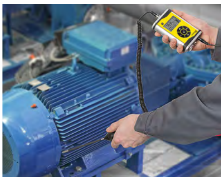
La sonda per le vibrazioni meccaniche con punta in acciaio inox è perfetta per eseguire controlli CND come gli esami dello stato di usura dei cuscinetti sui componenti delle macchine rotanti.
