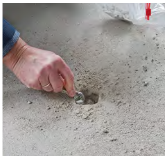
Fase 1: il campione viene prelevato come al solito su tutta la sezione trasversale del massetto e messo in un sacchetto.
