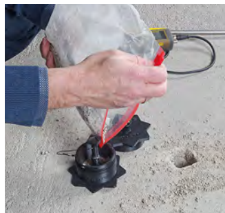
Fase 3: riempimento della camera di misurazione con il campione di materiale.
