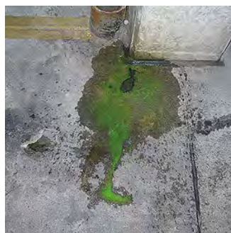
L'Uranin Green è già visibile a occhio nudo nel punto di perdita e, grazie all'eccitazione della fluorescenza con luce UV, è possibile effettuare una rapida rilevazione del tracer anche su ampie superfici.
