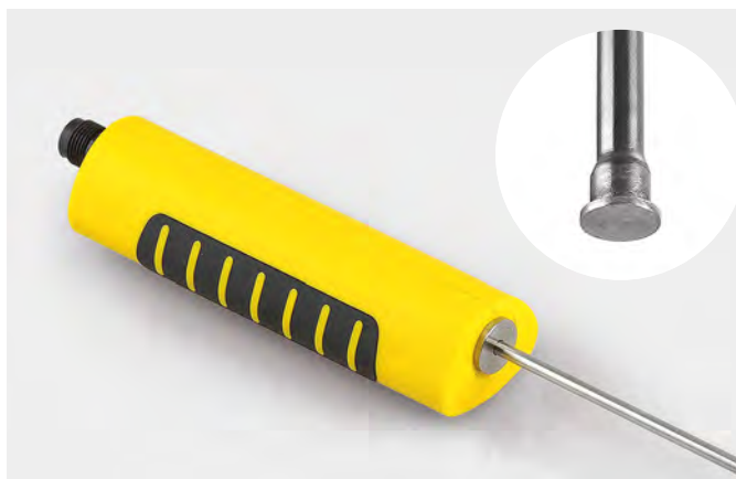
Sulla testa della sonda di misurazione lunga 150 mm (ø 3,5 mm) si trova un contatto d'argento (ø 6 mm), con cui viene rilevata la temperatura della superficie.
