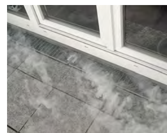
Impermeabilizzazione difettosa di una terrazza sul tetto.
